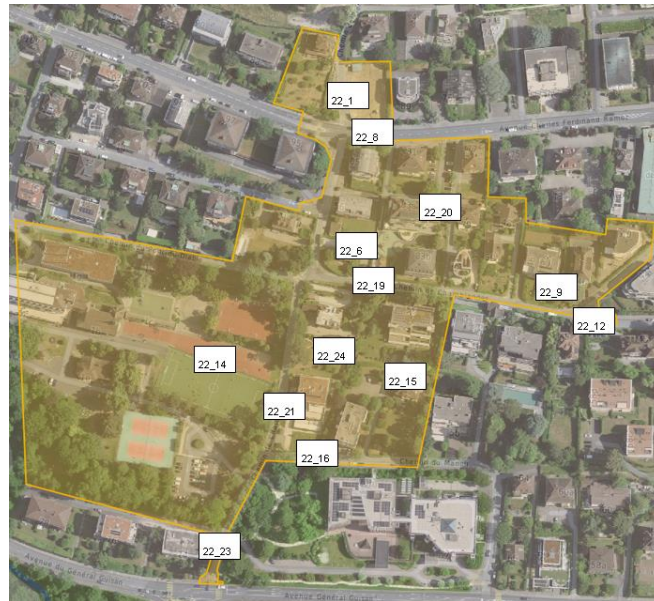
Bassins versants concernés : le projet permettra de mettre une importante surface de Pully en séparatif et donc de réduire la quantité d'eaux claires envoyées à la STEP, étape fondamentale en vue de sa future réhabilitation
